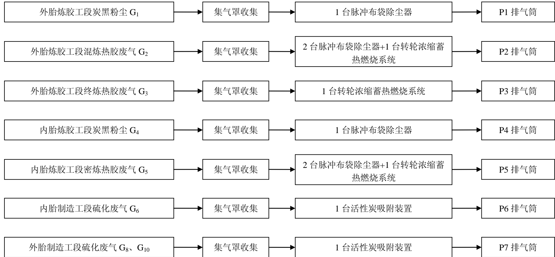
图 4.6-11 有组织大气污染源收集处理排放流程图
