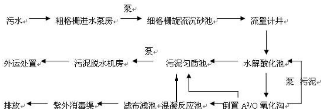
图 11.2-1 园区污水处理厂工艺流程
