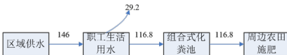
图 5-3 建设项目给排水平衡图（单位：t/a）
