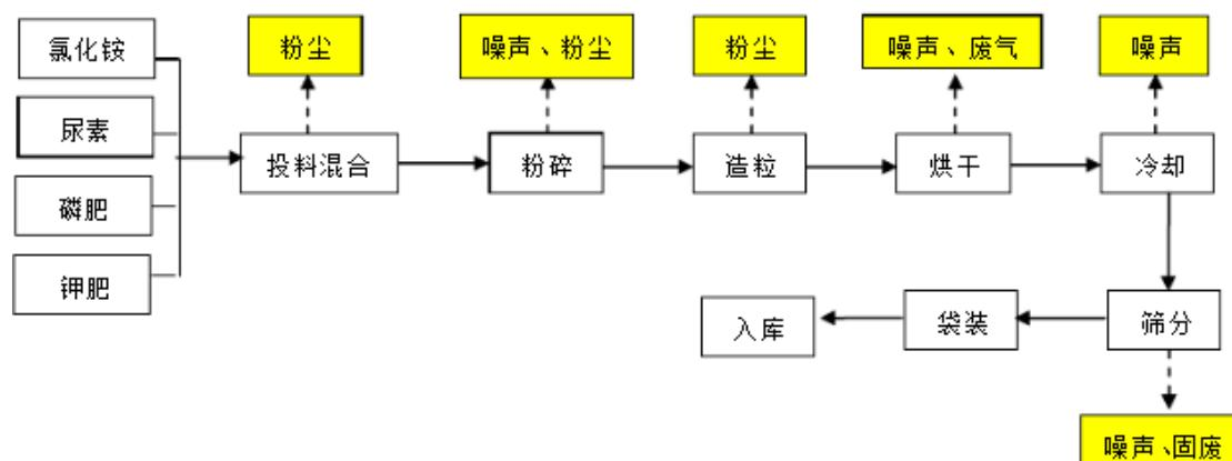
图 2.4-1 生产工艺流程及产污环节图
