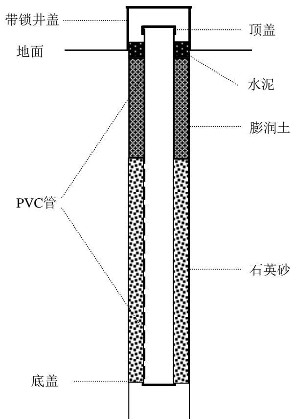
**图 3.1-4 地下水监测井剖面示意图**
