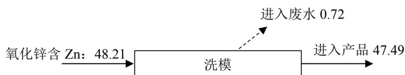
图 3.2.2-7 建设项目锌元素平衡图 (单位 t/a)
