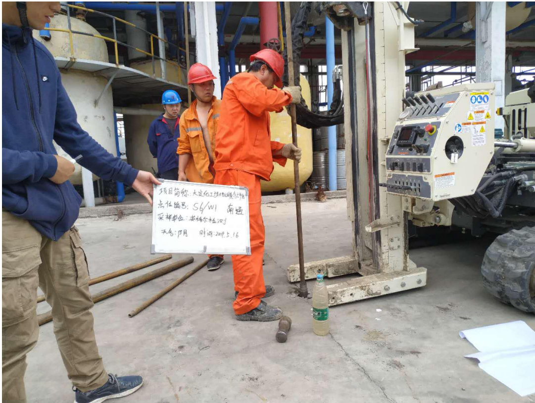
图 5.3-2 直推式环保取样钻机现场采样
