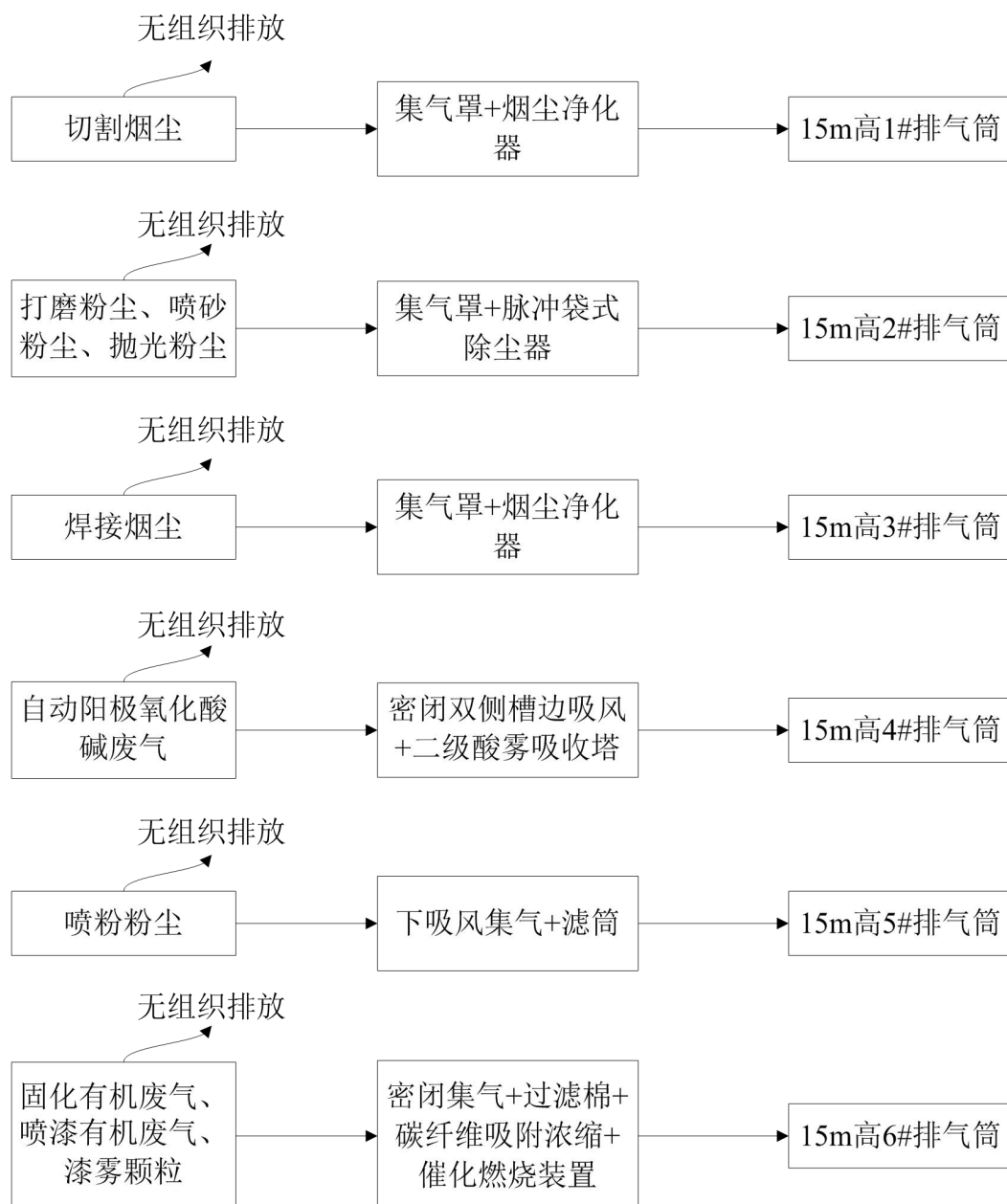
图 6.2-1 建设项目有组织废气处理走向图
