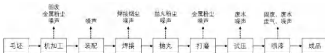
图2.4-2主体生产工艺流程图
